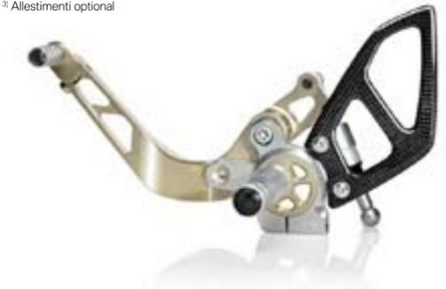
Pedane regolabili in alluminio fresato, estremamente resistente, con posizioni personalizzabili.
